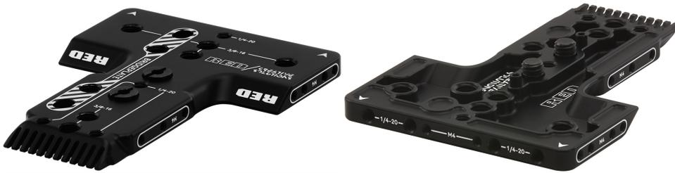
La V-RAPTOR® XL Riser Plate se fixe au bas de la caméra et vous permet de fixer des plaques de base de studio standard de 15 mm et 19 mm pour atteindre la hauteur optique correcte. Il fournit également des points de montage 1/4-20 et 3/8-16 pour des configurations de montage supplémentaires.
