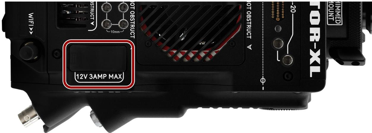
Les deux connecteurs femelles P-Tap (également connus sous le nom de D-Tap) fournissent 12 volts à une puissance maximale partagée de 3,0 ampères. Les ports sont protégés par un couvercle étanche. Ces ports sont protégés par un disjoncteur qui se réarme automatiquement.
