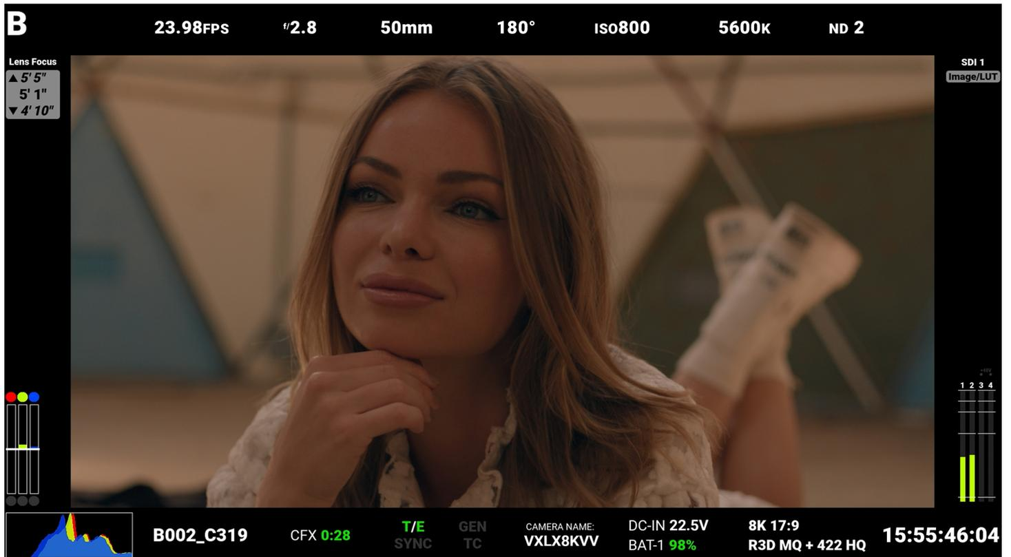
Figure : Moniteur SDI avec mode superposition technique SDI activé
