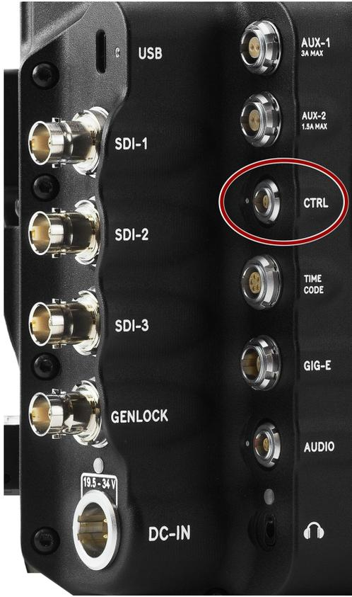
Le port femelle LEMO 4-Pin 00B CTRL est situé sur le côté gauche du corps de la caméra.
