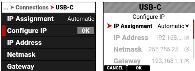
Lorsque vous êtes connecté à un réseau Ethernet, cela vous permet de détecter automatiquement une adresse IP ou de saisir manuellement une adresse IP, une adresse de masque de réseau et une adresse de passerelle (routeur).
