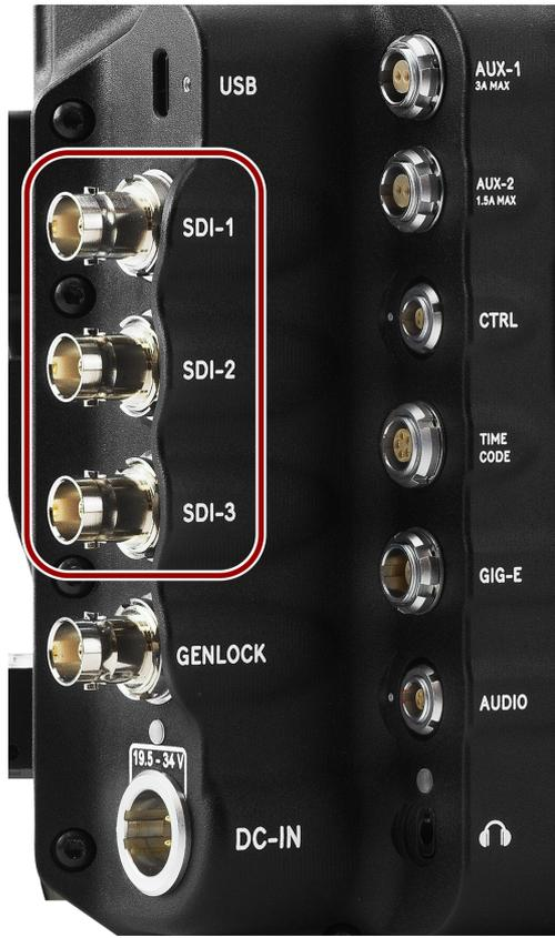
Les ports BNC mâles 75 ohms SDI 12G offrent une bande passante d'image de 12, 6, 3 ou 1,5 Gbps, idéale pour le format 4K 60P. Les autres caractéristiques sont les suivantes :
