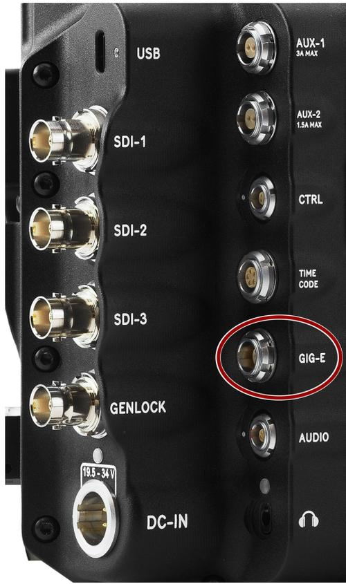
Le connecteur ODU GIG-E 9-pin 0L fournit une connexion Gigabit Ethernet 1000BASE-T (IEEE 802.3ab) pour le contrôle à distance de la caméra, la synchronisation des capteurs et des images selon le protocole Precision Time (SMPTE 2059-1) et l'accès au flux vidéo IP 1080p.
