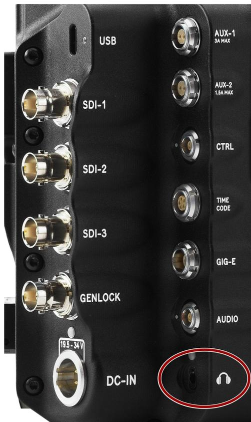
La prise stéréo de 3,5 mm fournit deux (2) canaux audio pour la surveillance. Pour obtenir une qualité optimale, utilisez des écouteurs à haute impédance.
