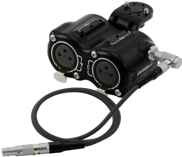
L'adaptateur DSMC3™ RED® 5-pin vers double XLR est une solution compacte pour transformer le port audio 5-pin en deux ports XLR 3-pin. Cet adaptateur offre deux ports XLR standard fournissant une alimentation fantôme de 48 volts, ainsi qu'une entrée micro et ligne qui se monte facilement sur votre V-RAPTOR®.
