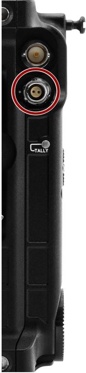
Le connecteur femelle ODU 2-Pin 0B fournit une alimentation régulée (+) de 12 V CC pour un viseur électronique (EVF). Le courant maximal soutenu est de 1 ampère. Ce port est protégé par un disjoncteur qui se réarme automatiquement.
