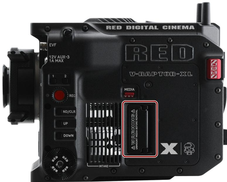
L'appareil contient un compartiment couvert sur le côté gauche où vous insérez la carte CFexpress.
