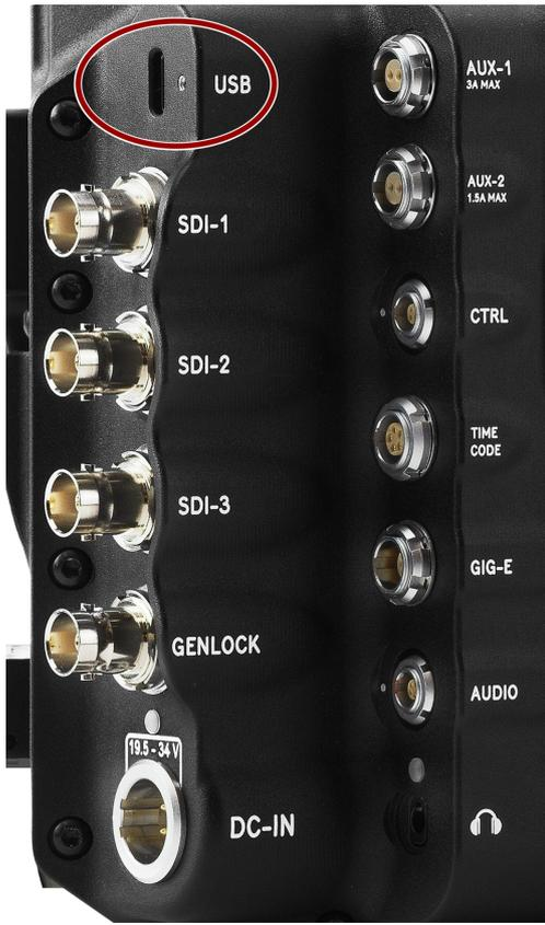
Ce port est principalement destiné aux connexions de données du protocole USB-C 3.0. Le connecteur de sortie d'alimentation USB-C fournit une alimentation de 5 volts. La consommation maximale de courant soutenu est de 0,9 ampère. Ce port est protégé par un disjoncteur qui se réarme automatiquement.
