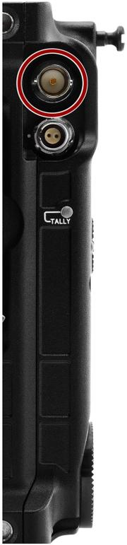
Le port BNC mâle du viseur électronique (EVF) 3G-SDI est contrôlé indépendamment des sorties arrière 12G-SDI. Certains paramètres tels que les outils et la mise à l'échelle de l'image sont liés à la vidéo du port d'accessoires supérieur.
