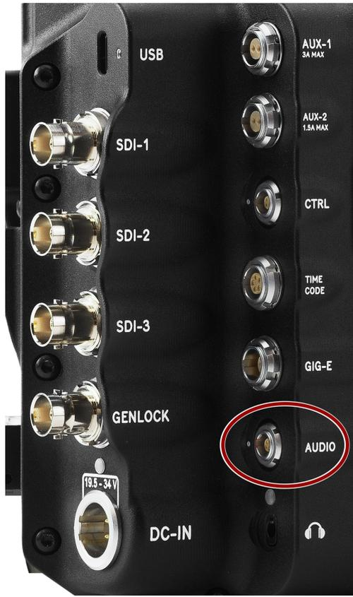
Le connecteur audio femelle LEMO 5-Pin 00B accepte l'audio à 2 canaux, Line, Mic, et fournit une alimentation fantôme +48V.
