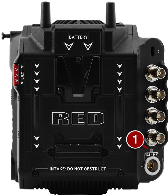
Figure : Caméra Corps Dos LED
