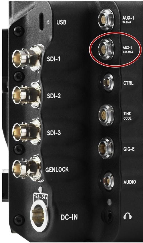
Le connecteur femelle ODU 2-pin 0B fournit une alimentation régulée (+) de 12 V CC lorsqu'une batterie haute tension est connectée à la caméra. Le courant maximal soutenu est de 1,5 ampère. Ce port est protégé par un disjoncteur qui se réarme automatiquement.
