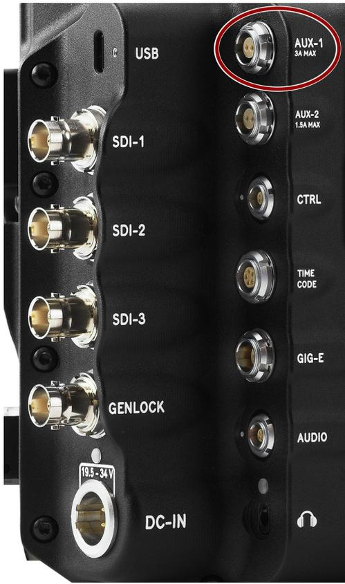
Le connecteur femelle ODU 2-pin 0B fournit une alimentation régulée (+) de 12 V CC lorsqu'une batterie haute tension est connectée à la caméra. Le courant maximal soutenu est de 3 ampères. Ce port est protégé par un disjoncteur qui se réarme automatiquement.
