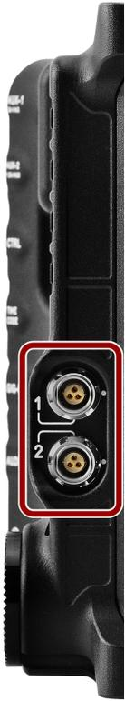
Deux (2) connecteurs Fischer OL à 3-pin fournissent une alimentation de 24 V (régulée) avec un courant maximal soutenu de 3 A. Chaque connecteur comprend également une entrée de déclenchement de marche/arrêt (R/S). Pour faire fonctionner le déclencheur de type fermeture de contact, court-circuitez la broche 3 (R/S) à la pin 1 (masse). Ce port est protégé par un disjoncteur qui se réarme automatiquement.
