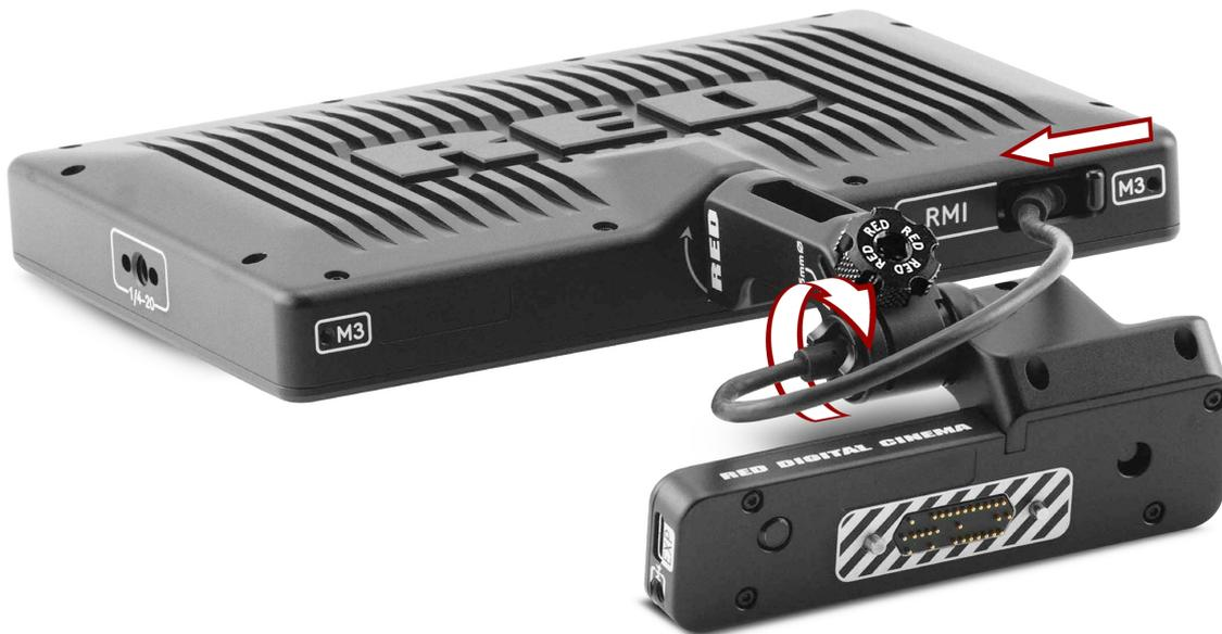
**NOTE :** Le câble RMI est fixé au moniteur de manière inclinée, comme le montre l'image. Le câble RMI de style USB-C DSMC3™ est un câble à-pin personnalisé, qui n'est pas compatible avec les ports de câble USB-C standard (notamment le port USB-C de la caméra arrière). Les ports EXP de la RMI sont destinés à une utilisation future et ne sont pas pris en charge actuellement.
