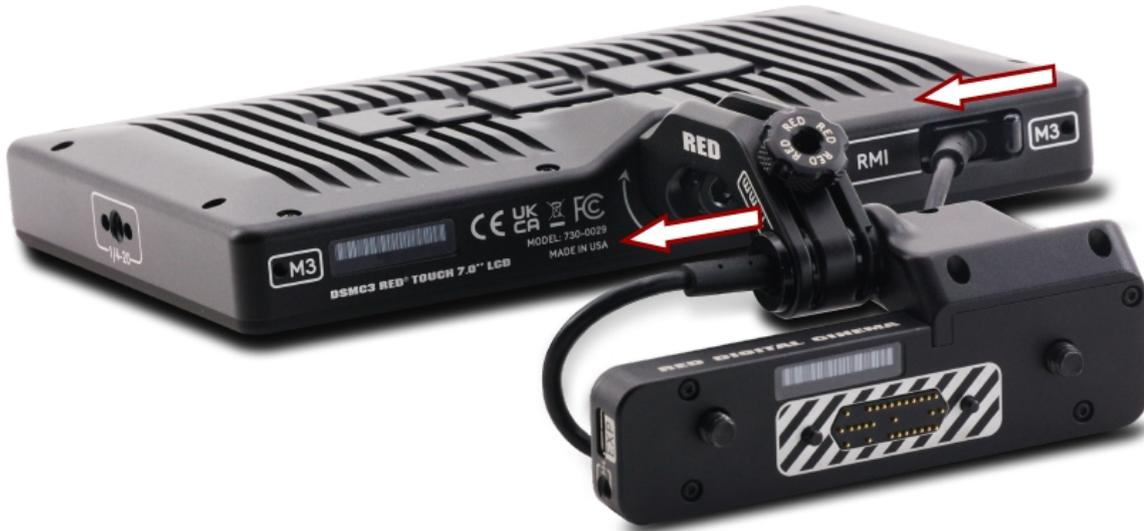
**NOTE :** Le câble RMI est fixé au moniteur de manière inclinée, comme le montre l'image. Le câble RMI de style USB-C DSMC3™ est un câble à-pin personnalisé, qui n'est pas compatible avec les ports de câble USB-C standard (notamment le port USB-C de la caméra arrière). Les ports EXP de la RMI sont destinés à une utilisation future et ne sont pas pris en charge actuellement.
