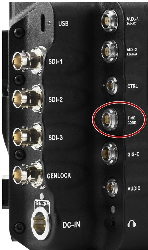
Le connecteur femelle LEMO 5-Pin 0B prend en charge l'entrée et la sortie Timecode SMPTE.
