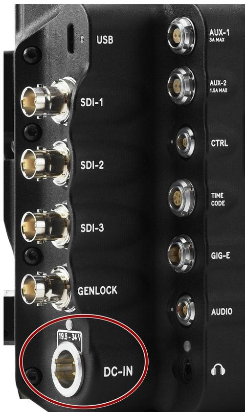
Le connecteur DC-IN mâle à 4-pin 2L de l'ODU accepte une alimentation d'entrée CC de +19,5 V CC à +34 V CC. Un conditionneur d'alimentation intégré protège contre les connexions à polarité inversée, la sous-tension, la surtension et la surintensité.
