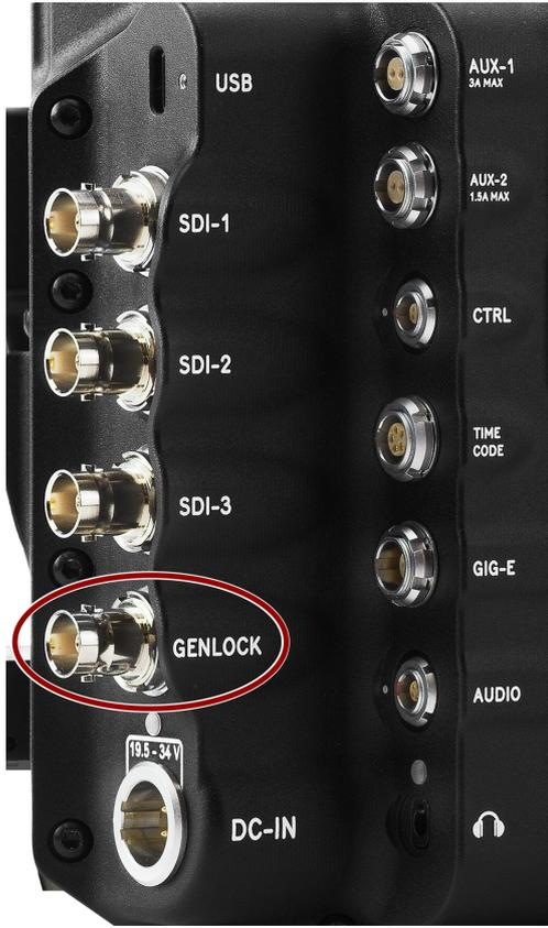
Le port BNC Genlock est un connecteur BNC mâle standard de 75 ohms qui accepte les signaux de synchronisation et de Genlock entrants.
